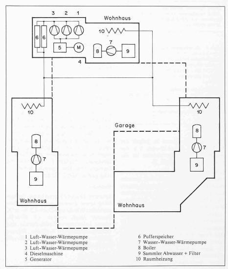
Bild 16. System-Beschrieb der Raumheizung
