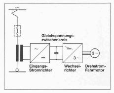
Bild 5. Blockschaltbild Drehstromantrieb
