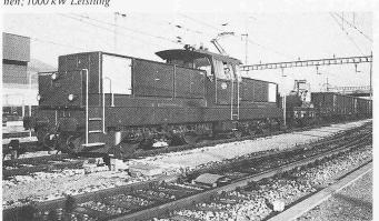
Bild 10. Diesel-Industrie-Rangierlokomotive DE 500, 500 kW Leistung
