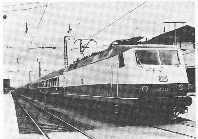
Bild 12. Elektrische Lokomotive der Deutschen Bundesbahn für Schnell- und Güterzüge, Reihe E 120, 5600 kW, v_{max} : 200 km/h mit Nutzbremse
