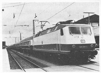
Bild 12. Elektrische Lokomotive der Deutschen Bundesbahn für Schnell- und Güterzüge, Reihe E 120, 5600 kW, vmax: 200 km/h mit Nutzbremse
