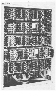
Bild 15. Ölgekühlter Stromrichter der Drehstromlokomotive E 120
