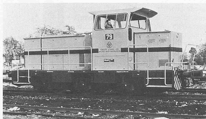
Bild 10. Diesel-Industrie-Rangierlokomotive DE 500, 500 kW Leistung
