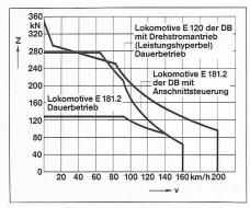
Bild 13. Zugkraft-Geschwindigkeitsdiagramm
