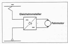
Bild 3. Blockschaltbild Anschnittsteuerung
