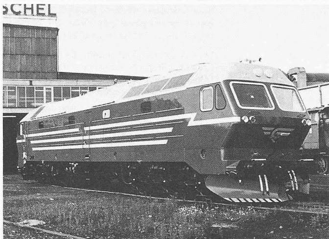
Bild 11. Diesellokomotive Di 4 der Norwegischen Staatsbahn; 3800 PS (2795 kW)
