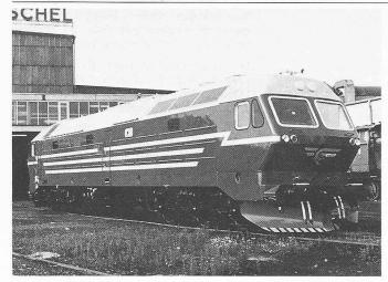
Bild 11. Diesellokomotive Di 4 der Norwegischen Staatsbahn; 3800 PS (2795 kW)
