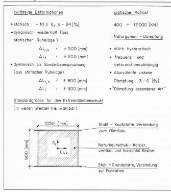
Aufbau und Abmessungen eines seismischen Hochleistungsisolators (3 - D) für den Extremalbebenschutz. Geometrie und Kautschukmischung sind für die vorhandene statische Auflast frei wählbar
