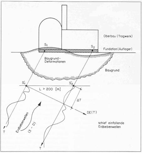
Überbeanspruchung des Tragwerkes infolge differentieller Auflagerbewegungen bei unterschiedlichen Eintreffenszeiten der Erdbebenwellen an den Auflagerpunkten.
