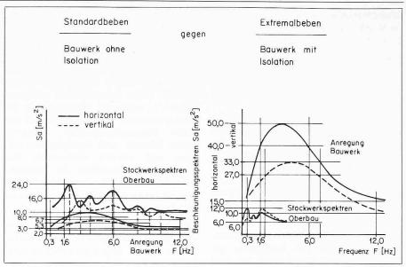
Bild 10. Schematische Darstellung der Isolierwirkung der räumlich schwimmenden Lagerung bei dreidimensionaler Erdbebenanregung; Standardbeben auf Bauwerk ohne Isolation gegen Extremalbeben auf Bauwerk mit Isolation
