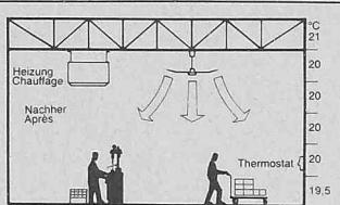
Deckenventilatoren wird die Wärme durch Umwälzung in den Aufenthaltsraum gebracht und somit zurückgewonnen.
