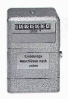
Ölzähler HZ 4 Einbau an alle Brennerfabri-Einbau an alle Brennertabri-kate. In Druckleitung zwischen Brenner und Düse. Mess-Brenner und Dih, Genauigkeit 1%. bereich 1–50 l/h, Genauigkeit
