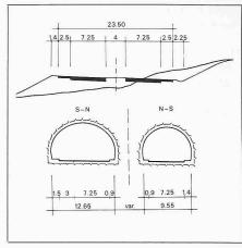
Bild 3 (oben). Normalprofile der N2 in der Leventina
