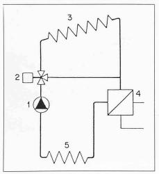
Kombination Luftregister/Erdkollekor 1 Umwälzpumpe 2 Verteilventil 3 Luftregister Carport 4 Verdampfer, Wärmepumpe 5 Erdkollektor
