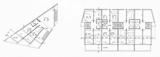
$Grundriss, Obergeschoss.\ Kompakte\ Form\ mit\ grosser\ S\"{u}dfassade,\ n\"{o}rdliche\ Eckzimmer\ durch\ Auskragungen\ von\ S\"{u}den\ belichtet$
