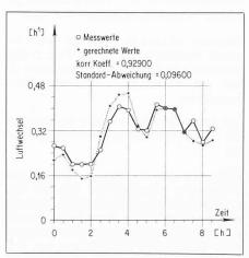
Vergleich von gemessenem und berechnetem Luftwechsel im «Messgebäude Maugwil»; die Eingabewerte für die Druckverteilung wurden von den Windmessdaten abgeleitet
