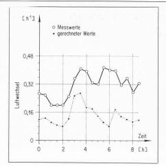
Vergleich von gemessenem und berechnetem Luftwechsel im «Messgebäude Maugwil» der EMPA. Die Diskrepanz ist auf die verwendeten Druckverteilungs-Eingabewerte zurückzuführen
