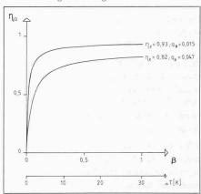
Bild 4. Brennerauslastung als Funktion der Kesselnennleistungsauslastung (verzerrte Darstellung)
