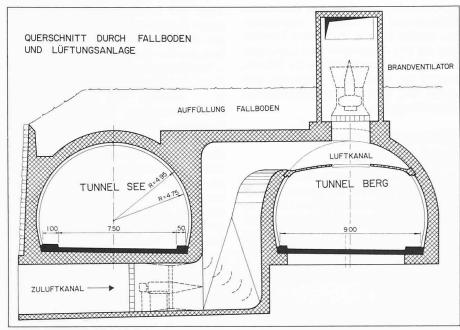
Bild 3. N2-Achereggtunnel. Tunnelbelüftung
