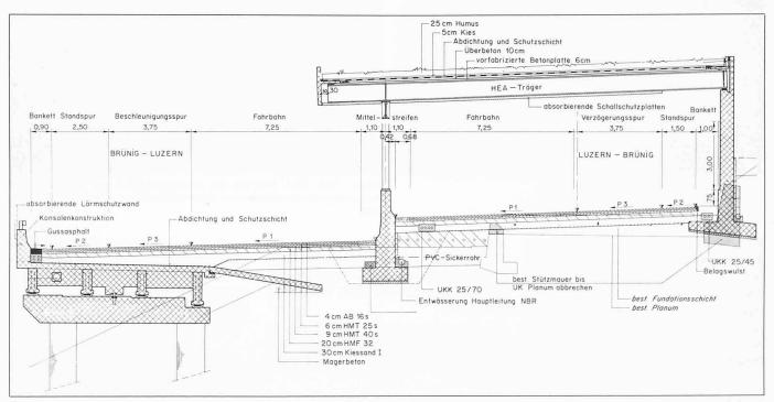
Bild 4. Normalprofil Abschnitt Süd. Trassee mit Konsolkonstruktion (Baulos 15) und Lärmschutzgalerie (Baulos 62)
