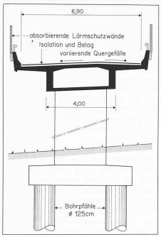
Bild 11. Rampenbrücke Ost. Normalquerschnitt
