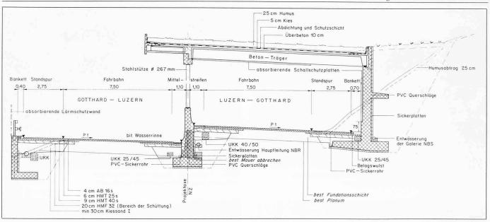
Bild 3. Normalprofil Abschnitt Nord. Trassee (Baulose 22 und 33) und Lärmschutzgalerie (Baulos 60)
