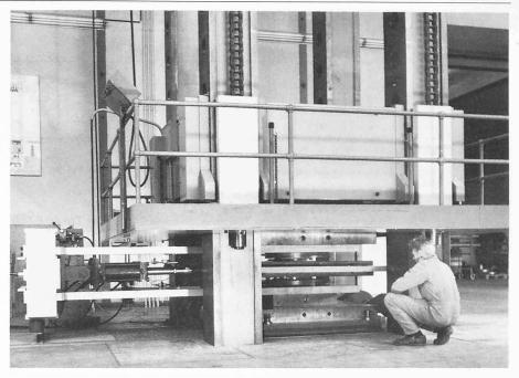
Bild 3. Versuchsanordnung in der 20-MN-Presse der EMPA
