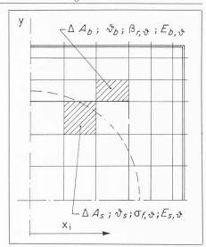
Bild 10. Berechnung der Knicklast bei erhöhten
