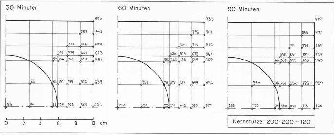
Bild 6. Temperaturentwicklung in Kernstütze 200 · 200–120
