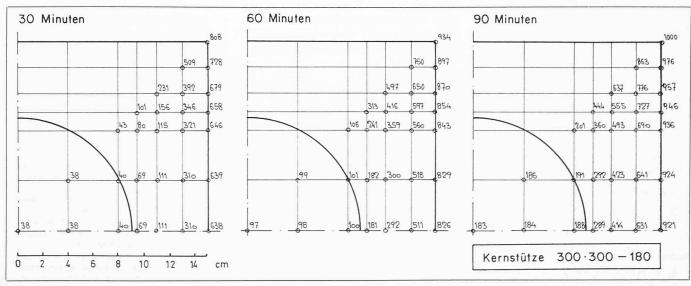
Bild 8. Temperaturentwicklung in Kernstütze 300 · 300-180
