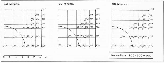
Bild 7. Temperaturentwicklung in Kernstütze 250 · 250–140
