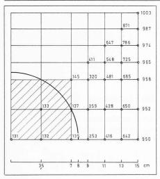
Typisches Netzwerk für Berechnung mit Finiten Elementen. Die angegebenen Zahlen bedeuten die Temperaturen nach 90 Minuten Normbranddauer. Der Rundkern wurde durch flächengleichen quadratischen Kern ersetzt
