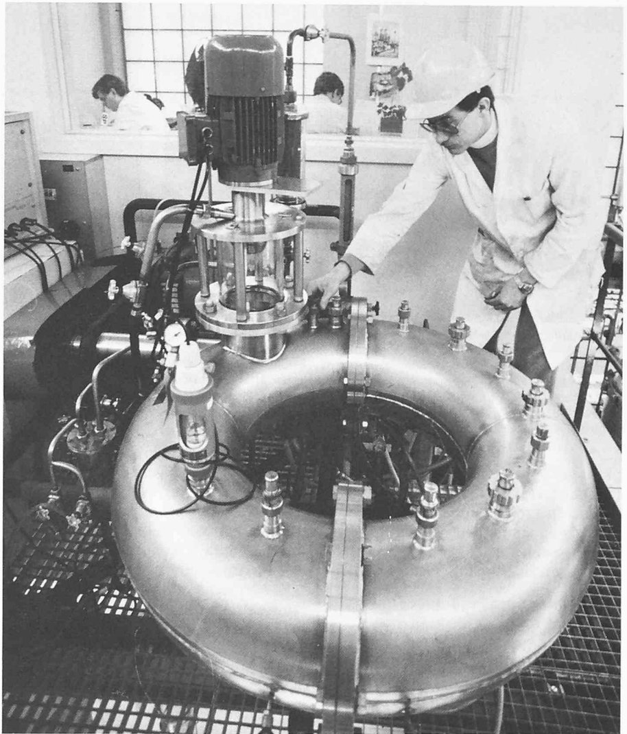
Torus-Bioreaktor (Eigenentwicklung vom Institut für Verfahrens- und Kältetechnik ETHZ; Prof. Widmer). Kreisförmiger Bioreaktor mit einem Fassungsvermögen von 100 l, geeignet zur Kultivation von Mikroorganismen in hoch viskosen Nährmedien. Links im Bild sichtbar die horizontalliegende Antriebswelle, im Zentrum der vertikal stehende Schaumabscheider. Die am Reaktor angebrachten Stützen ermöglichen die Aufnahme von Messprofilen
