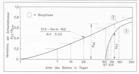
Bild 4. Schwindverlauf des Betons nach Norm SIA 162 ( $\varepsilon_{s2} = 2$ . Bauphase,  $\varepsilon_{s3} = 3$ . Bauphase)
