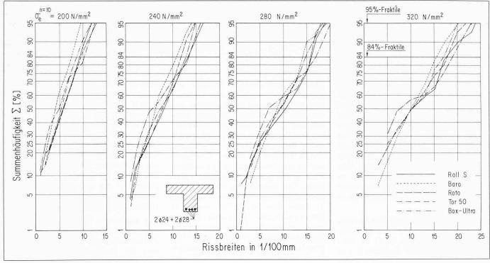
Rissbreiten in Funktion der Summenhäufigkeit. Vergleich des Haftvermögens der verschiedenen Stahlsorten anhand der Balken mit Normalbewehrung Aufgetragen sind die Rissbreiten im Bereich mit konstantem Biegemoment für vier wichtige Spannungsstufen. Ein Vergleich der Rissdiagramme zeigt, dass das Haft vermögen der untersuchten Armierungstypen etwa gleichwertig ist, denn die betreffenden Rissbreiten weichen jeweils nur um höchstens ± 2/100 mm voneinander ab
