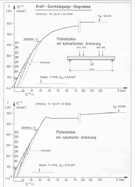
Bild 4. Kraft-Verformungs-Diagramme. Durchbiegung in Feldmitte in Funktion der Belastung bzw. der rechnerischen Stahlspannungen. Oben: Diagramme für kaltverformte Stähle. Unten: Diagramme für naturharte Stähle. Unter Risslast ver-
