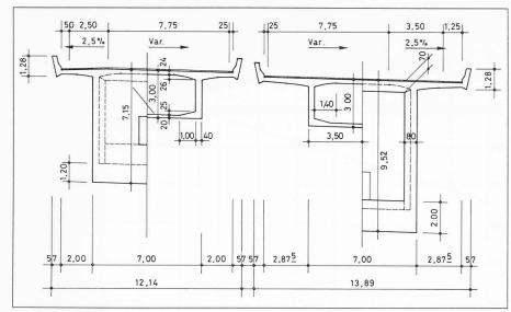
Bild 9. Brückenquerschnitte
