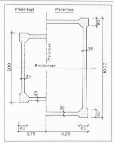
Bild 10. Pfeilerquerschnitte
