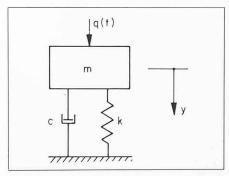
Bild 7. Einmassenschwinger mit Dämpfung
