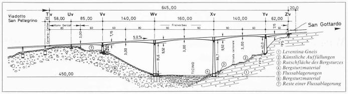
Längsschnitt des Viadotto Biaschina. Talseitige Brücke mit geologischem Profil
