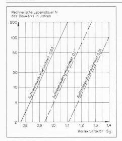
Bild 15. «Sicherheitsdiagramm» gemäss Englischer Windnorm
