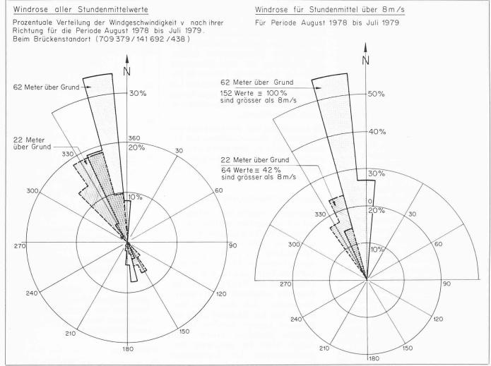
Richtungsabhängigkeit der mittleren Windgeschwindigkeit Bild 13.
