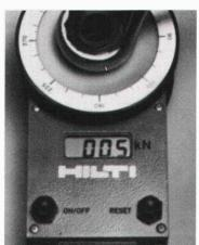
Mit dem Dübel-Prüfgerät die ausgeführte Befestigung praxisnah prüfen.
