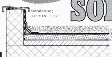
Schutzschicht SOPRALEN EJ 3.5 + EV 3.2 Wärmedämmschicht Dampfsperre
