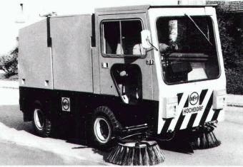
MFH 2100 die bewährte Kehrmaschine, Arbeitsgeschwindigkeit stufenlos 0-25 km/h, 2,41 Ford-Diesel-Motor, Fassungsvermögen Schmutzbehälter 1600 l, Wassertank 500 l, sehr schmal (Gesamtbreite 125 cm).
