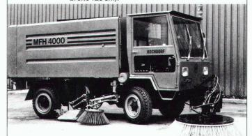
MFH 4000 die neue leistungsstarke Kehrmaschine, Geschwindigkeit stufenlos 0–60 km/h, auf gefedertem Chassis mit Allrad-Antrieb und Allrad-Lenkung. Meili-VM-Diesel-Turbo-Motor, Fassungsvermögen Schmutztank 4000 l, Wassertank 700 l, Gesamtgewicht 7000 kg. Kann als Dreiseiten-Kipper, Transporter und Winterfahrzeug eingesetzt werden.
