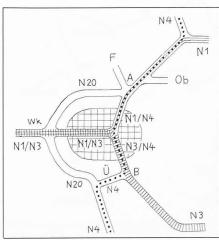
Bild 1. Schema des Expressstrassen-Y mit Umfahrungsautobahn (bisheriges Konzept) A Aubrugg, B Brunau, F Flughafen, Ob Oberland-Autobahn, Ü Üetlibergtunnel, Wk Weiningerkreuz
