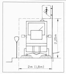
Bild 5. Minimales Lichtraumprofil für Reinigungsfahrzeuge
