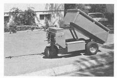
Bild 3a. Elektrogehwagen. Kippermodell
