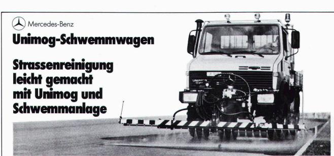
Mit dieser Schwemmanlage, bestehend aus dem hydraulisch verstellbaren Schwemmbalken und dem auf der Brücke oder einem Anhänger mitgeführten Wasserfass, lassen sich Strassen, Plätze, Werkhöfe und Baustellenausfahrten rasch und gründlich
