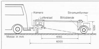
Bild 2 (oben). Zugfahrzeuge und Anhänger «DQM 2» (ISETH)
