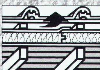
**4.** Das ideale Format  $213 \times 47 \text{ cm} = 1\text{m}^2$  bringt den Vorteil, dass die Isolationsplatte statisch richtig auf mindestens 3 Sparren aufliegt.
