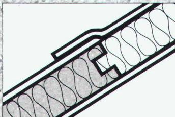
**2.** Das rutsch- und tritt-feste Unterdach bietet sicheren Schutz gegen Wind, Flugschnee und eindringendes Wasser.
