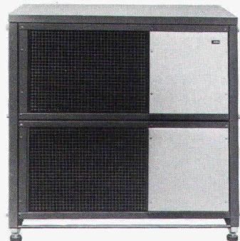
Die AEG Wärmepumpe besteht aus zwei Wärmetauschern und einem geschlossenen Kältekreislauf. Darin wird die Außenluft auf eine höhere Temperatur hochgepumpt und diese Wärme ans Heizungswasser abgegeben. Dank der neuartigen Modulbauweise kann die Heizleistung dem jeweiligen Wärmebedarf individuell
