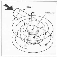
Bild 4. Strömungsvorgänge in einer Wirbeldrossel
