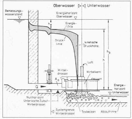
Bild 5. Druckhöhenverlauf
