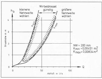
Bild 6 (oben). Abflusskurven einer Wirbeldrossel NW 200 mm
