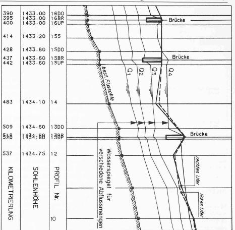
Bild 4. Ausschnitt aus einem Kapazitätslängenprofil
