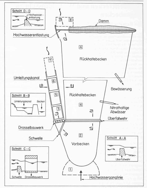
Bild 6. Mehrzweckspeicher am Modderspruit, Struktur des Zellenmodells
