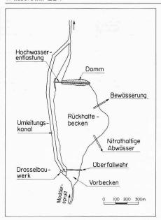
Bild 5. Mehrzweckspeicher am Fluss Modderspruit bei Johannesburg, Lageskizze
