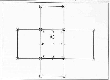
Bild 5. Betrachtetes Plattenfeld und Nachbarfelder, Punkte 1 bis 9: Bemessungspunkte des Plattenfelds
