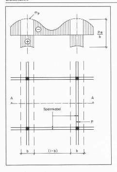
Bild 6. Verlauf des Zwängungsmomentes m. im Schnitt A-A
