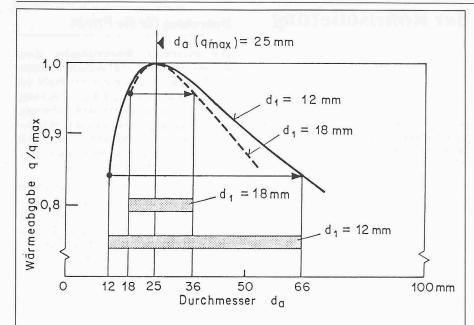
Isolationsmaterial mit  $\lambda_2$  = 0,05 W/m K, Wärmeübergangszahl  $\alpha_a$  = 4 W/m² K. Der schraffierte Bereich stellt Isolationsausführungen dar, welche grössere Wärmeverluste erzeugen als das nackte Rohr.
