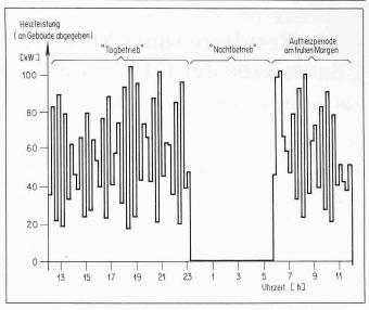
Bild 5. Beispiel eines Profils für diejenige Heizenergie, die dem Gebäude von der Heizungsanlage zugeführt wird
