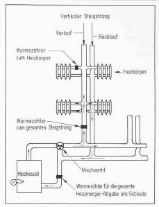
Bild 1. Schema der Heizungsanlage mit wesentlichen Messfühlern
