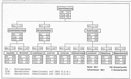
Bild 8. Resultat der Nutzwertanalyse für die N-6 Wimmis-Rawil-Uvrier
