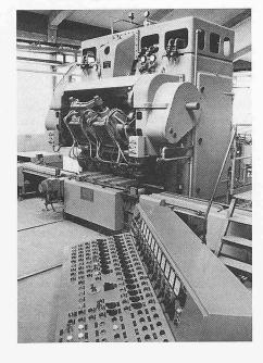
feucht gelagert wird. Der Weg in die Backsteinfabrikation führt vom Sumpfhaus über den Siebrundbeschicker, wo mit Bedampfung die Plastizität erhöht wird, zur Doppelstrangpresse mit Vakuumkammer. Mundstück der Presse und Abschneider formen den Backstein, der gestapelt und getrocknet dann den Brennofen durchläuft. Die Jahresleistung beträgt 50 Mio. Stück.
