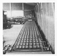
Bild 2. Engoben-Trocknungsstrecke
