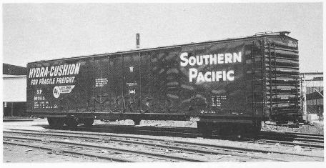
Bild 2. Geschlossener vierachsiger Güterwagen amerikanischer Bauart beim Verlassen des Herstellerwerkes in fabrikationsneuem Zustand.
