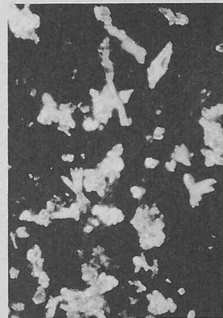
Kalkausfällung mit Crustex (600× vergrössert)
