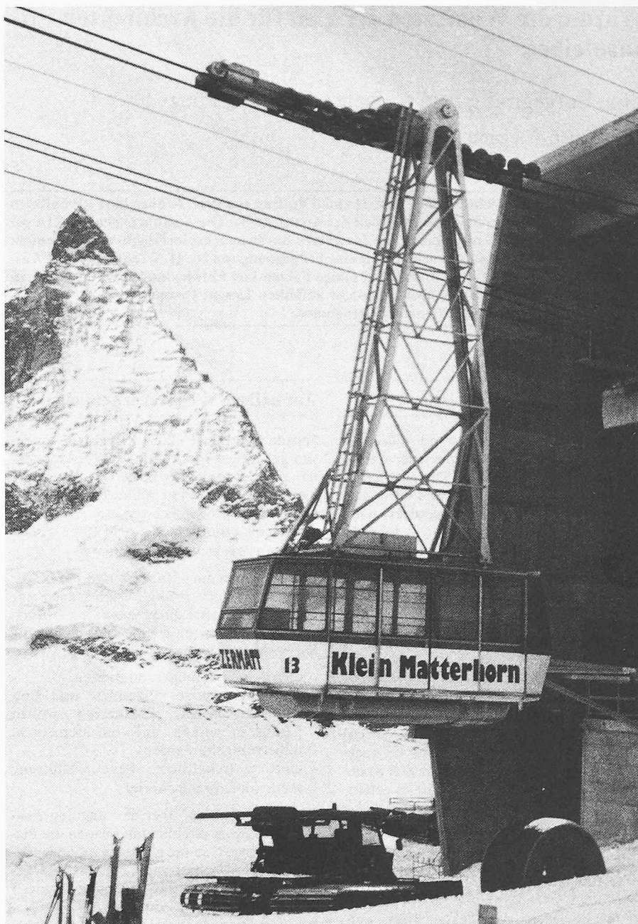
Bei allen Grosskabinenbahnen in der Schweiz gehört heute die elektronisch gesteuerte Bremse zur selbstverständlichen Einrichtung. BBC lieferte für die Luftseilbahn auf das Kleine Matterhorn bei Zermatt nicht nur Antriebseinheit und Umformergruppe, sondern auch die gesamte Antriebsregelung und -steuerung
