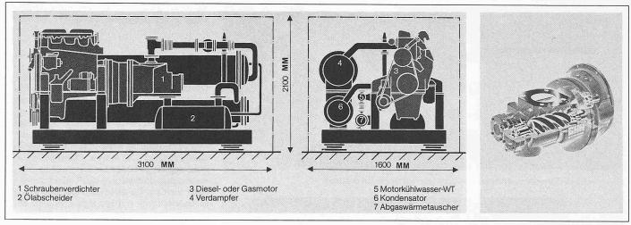
Schnitt durch Diesel-Gaswärmepumpe mit Schraubenverdichter (rechts)
