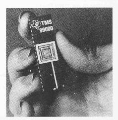
Mikroprozessor für Haushaltmaschine (50 000 eingebaute Transistorfunktionen)
