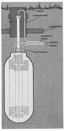
Anlage zur Rückgewinnung von Wärme aus dem Haushalt; das System besteht aus einem Speicher und einem Wärmetauscher (rechts)
