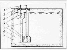
Druckloser Kunststoff-Wärmespeicher. 1 Lötanschluss Beladewärmetauscher, 2 Lötanschluss Entladewärmetauscher, 3 Dom Ø 420 mm, 4 Wärmetauscher, 5 Steig- bzw. Sinkkamin, 6 Speichermedium (z.B. Wasser), 7 Isolation
