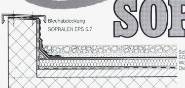
Schutzschicht SOPRALEN EJ 3.5 + EV 3.2 Wärmedämmschicht Dampfsperre
