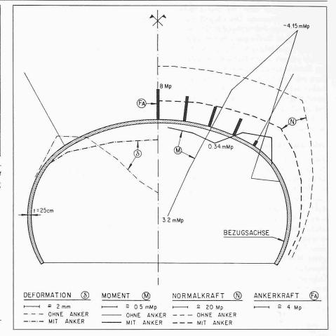
Bild 7b. Schnittkräfte und Deformationen des Ge-
