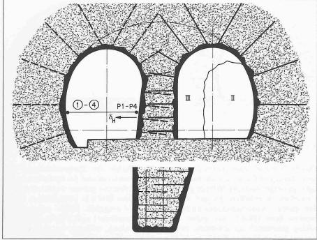
Bild 10. Systemankerung der Pfeilernase und der beiden Tunnelröhren. Ausbruchetappen II, III (s. Bild 11) Messlängen für Konvergenzmessungen 1-4 (s. Bild 11)
