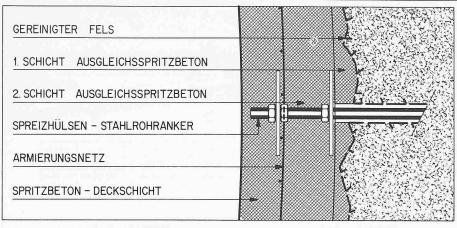
Bild 9. Aufbau der Verkleidung mit Spritzbeton und Ankern im Bereich 4
