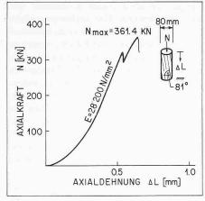
Kraft-Verformungsdiagramm für einen Bild 2. einachsigen Druckversuch an einer Gneisprobe
