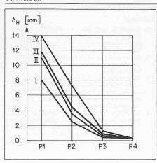
Bild 12. Deformation  $\delta_H$  der Messpunkte P1-P4 infolge der Abschläge I-IV
