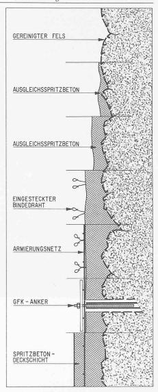
Bild 6. Schematischer Aufbau der Spritzbetonauskleidung
