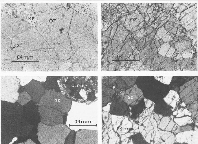
Bild 5. Dünnschliffphotos von gesundem (links) und desaggregiertem entfestigtem Cacciola-Granit (rechts) im Durchlicht (obere Reihe) und in polarisiertem Licht (X Nicols, untere Reihe). QZ: Quarz, KF: Kalifeldspat, P: Plagioklas, CC: Kalzit, GLI + EP = Glimmer+Epidot.
