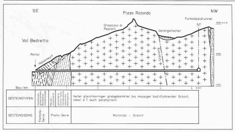
Bild 3. Geologisches Befundprofil durch den Fensterstollen Bedretto
