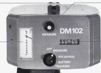
Starttaste (Dauer einer Messung: 8 Sekunden)
