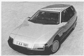
Bild 6. Forschungswagen von Daimler-Benz. Günstiger Luftwiderstand, hohe Sicherheit und Leichtbau charakterisieren die Karosserie. Der c...-Wert des Fahrzeugs liegt unter 0,3. Alternative Antriebsaggregate des komfortablen Reisefahrzeugs sind ein aufgeladener 3,3-Liter-V6-Dieselmotor, ein 3,8-Liter-V8-Ottomotor mit Zylinderabschaltung (Leistung jeweils 110 kW) sowie - als Option auf eine fernere Zukunft - eine Gasturbine
