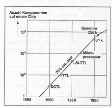
Bild 1. Anzahl Komponenten auf einem Chip in einem Bauelement der Mikroelektronik. Die Abkürzungen DCTL, TTL, LSI deuten auf die verschiedenen Generationen von Schaltkreisen hin
