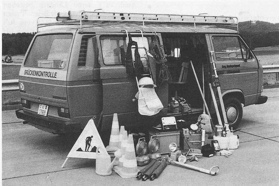
Bild 1. Fahrzeug und Gerät zur Brückenkontrolle
