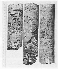
Bild 3. B-065 Bohrkerne aus Stampfbeton, Baujahr 1925. Foto EMPA 57751
