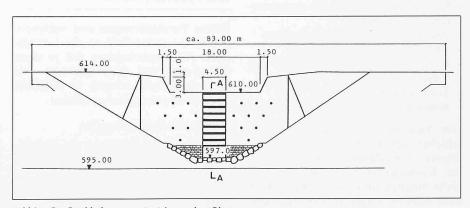
Bild 1. Die Rückhaltesperre, Ansicht aus dem Oberwasser
