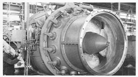
$Doppel tregel bare (4 \ Lauf schaufeln, 16 \ Leit schaufeln) \ Escher-Wyss-Kaplan rohrturbine \ mit \ Kegel radge triebe$
