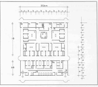
Bild 14. Grundrissvariante einer Betriebseinheit, «Operative Therapie» mit 5 OP-Funktionseinheiten; zu Bild 14 und 15, 1 OP-Funktionseinheit, 2 Sofortlabor, 3 Dienstraum Ärzte, 4 Diktatkabinen, 5 Umkleideeinheit, 6 OP-Plattenreinigung, 7 Leitstelle, 8 Patientenschleuse, 9 Aufwachraum, 10 Aufenthalt Personal, 11 Reinigungsgeräte, 12 Versorgung, 13 Entsorgung, 14 Gerätepflege, 15 Geräteraum
