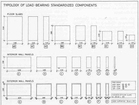
Typologie des JANKOSWISS-Baukastensystems. Oben: geometrische Grundlage; unten: das Sortiment von Bauteilen abgeleitet aus dem geometrischen System
