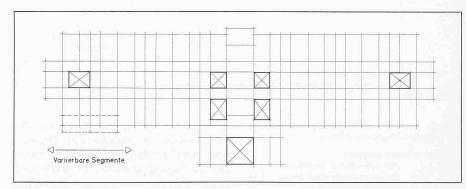
Bild 11a. Die Elementierung der Funktion führt zur Elementierung der Bauelemente; ein einfaches Beispiel: die Anzahl der durch die Vorzugsmasse bestimmten Deckenplatten
