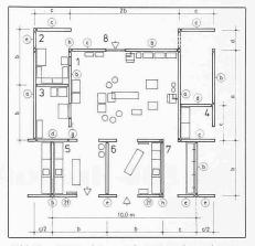
OP-Funktionseinheit (quadratisch), Be-Bild 18 standteil der Grundrissvariante im Bild 15, 1 Operationsraum, 2 Schaltraum, 3 Messraum, 4 Lagerraum (z. B. Schienen-), 4a Substerilisation, 5 Ausleitung/Entsorgung, 6 Einleitung, 7 Waschraum Ärzte, 8 Versorgung - reine Güter
