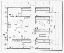
Bild 19. OP-Funktionseinheit (rechteckig), standteil der Grundrissvariante in Bild 15, Erläuterung: siehe Bild 18
