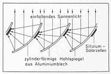
Bild 3. Durch Fokussierung der Lichtstrahlen lässt sich die gletche Leistung wie bisher mit einem Viertel bis einem Drittel der Solarzellenfläche erzeugen. Die Hohlspiegel selbst wirken dabei als Wärmeableiter für die Solarzellen [11]
