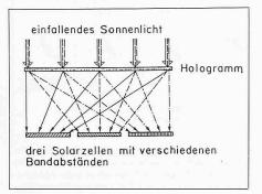
Bild 6. Ein speziell angefertigtes Hologramm teilt das einfallende Sonnenlicht in verschiedene Spektralanteile auf und fokussiert diese auf mehrere Solarzellen aus Halbleitern mit geeigneten Bandabständen. Der praktisch erreichte Gesamtwirkungsgrad liegt heute bei über 30 Prozent [12]
