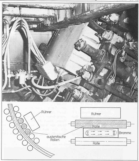
Bild 5. Elektromagnetischer Linearrührer in einer Brammenstranggiessanlage Oben: Photographie des Segmentes mit eingebautem Rührer Unten: schematische Darstellung
