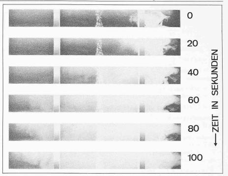
Versuch zur Ermittlung der Durchmischungsverhältnisse im Wassermodell durch Farbzugabe
