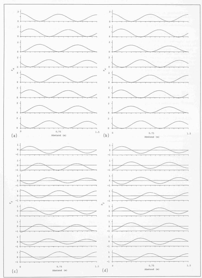
Bild 15. Geschwindigkeiten  $V_{xo}$  und  $V_x$  eines Flüssigkeitsballens auf dem Weg durch den Rührbereich, dargestellt für acht verschiedene Zeiten. (a)  $V_{xo}$ ,  $V_x$  symmetrische Anregung der Spulen, (b)  $V_{xo}$ ,  $V_x$  asymmetrische Anregung der Spulen, (c)  $V_y$  symmetrische Anregung der Spulen, (d)  $V_y$  asymmetrische Anregung der Spulen.
