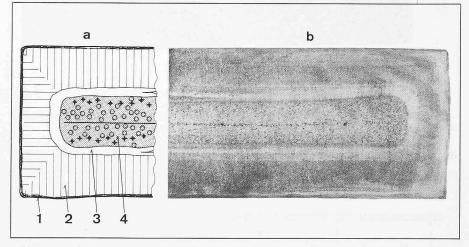
Bild 7. Querschnitt einer durcherstarrten Bramme unter Einfluss von nichtoptimiertem Rührverfahren (a) schematisch, (b) Tiefätzung (1) Abschreckschicht, (2) gerichtete Erstarrung, (3) weisse Linien, (4) ungerichtete Erstarrung
