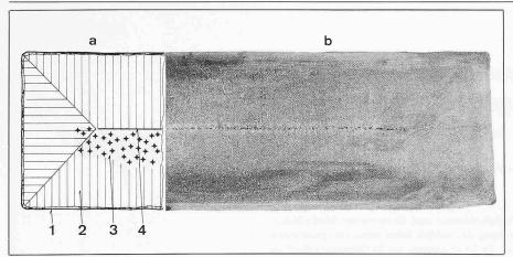
Bild 3. Querschnitt einer durcherstarrten Bramme
