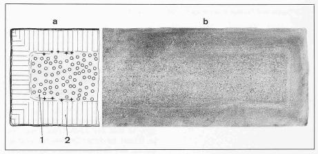
Querschnitt einer durcherstarrten Bramme unter Einfluss von optimiertem Rührverfahren (a) schematisch, (b) Tiefätzung; (1) ungerichtete Erstarrung, (2) gerichtete Erstarrung
