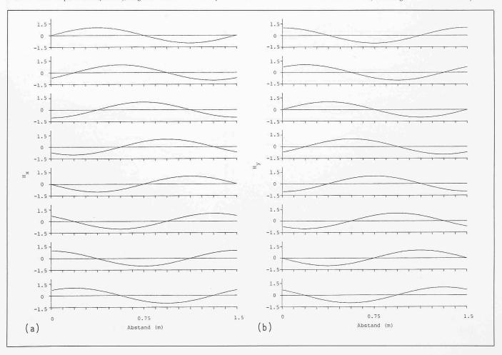
Bild 14. Kraftdichten  $F_x$  und  $F_y$  über y gemittelt als Funktion von x für acht verschiedene Zeiten innerhalb einer Periode (normiert). (a)  $F_x$  für symmetrische Anregung der Spulen, (b)  $F_x$  für asymmetrische Anregung der Spulen, (c)  $F_y$  für symmetrische Anregung der Spulen, (d)  $F_y$  für asymmetrische Anregung der Spulen
