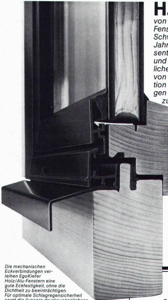
Die mechanischen Eckverbindungen verleihen EgoKiefer Holz/Alu-Fenstern eine gute Eckfestigkeit, ohne die Dictheit zu beeinträchtigen. Für optimale Schlagregensicherheit sorgt die äussere druckausgeglichen Falzzone.
