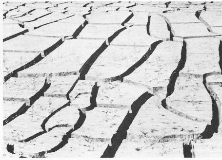
Kiesschlamm nach natürlicher Austrocknung im Kiesschlammweiher. Die breiten Trockenrisse deuten auf die hohe Feinheit des Abfallstoffes
