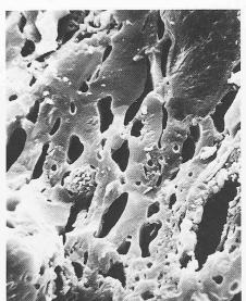
Rechts: Grobkristalliner Scherben; Mischung: 20% Opalinuston, 80% Kiesschlamm
