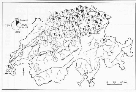
Bild 3. Kalzit- und Dolomitgehalt schweizerischer Kiesschlämme [3]
