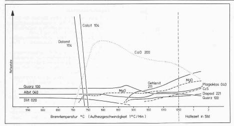
Darstellung des Reaktionsverlaufes der einzelnen Mineralphasen während des Brennens des Kiesschlammtyps G. Aufnahme mit der Röntgendiffraktometer-Heizkamera
