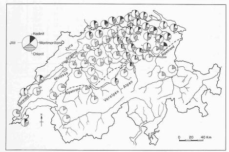
Bild 4. Tonmineralverteilung in schweizerischen Kiesschlämmen [3]
